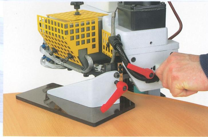
Führung des Verleimteils durch die höhenverstellbare Führungsplatte
