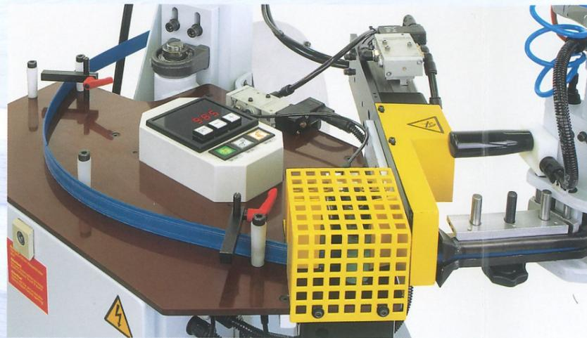
Die Kanten werden automatisch auf das eingegebene Maß abgelängt
